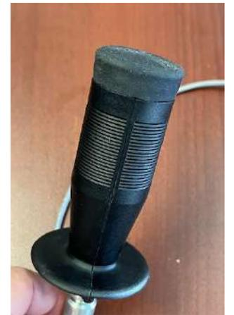
*Les boutons et les capuchons sont soumis à une ingénierie inverse et imprimés par ART dans les matériaux Nexa3D xCE et xFLEX pour être installés sur des nacelles.*
