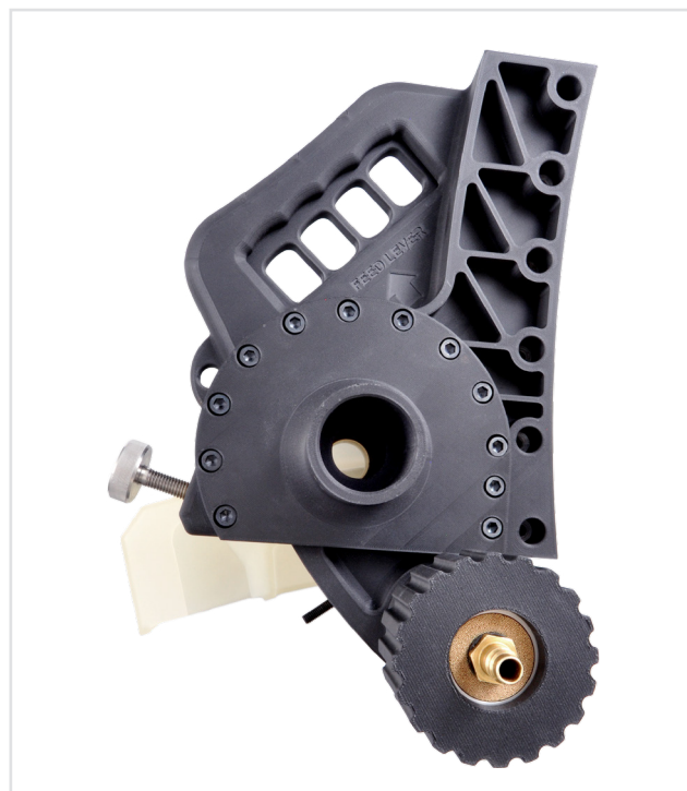
Le boîtier de la scie circulaire Siemens a été imprimé en Onyx, une base en nylon avec de la poudre de fibre de carbone, puis renforcé avec de la fibre de carbone continue.
